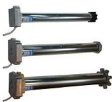
Standardni motorji za garažna vrata so LH-Motorji – za  $\varnothing 70$  mm ali  $\varnothing 125$  mm osovino z možnostjo odpiranja v sili z monokomando. So brez sprejemnika, z močjo dviga do 160 kg . Hitrost LH – motorjev je 12 obratov na minuto.
